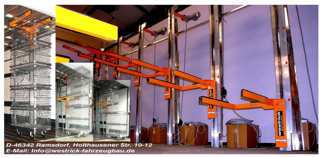
z. B. Textillogistik zum Auf- und Abstapeln von Klappkörben ermöglicht weitere Korbebenen für die Optimale Nutzung des Fuhrparks z. B. von 200 Körben auf 250
